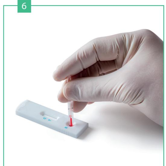
Vider le contenu de la pipette dans le puits «S» de la cassette, en appuyant sur la poire.
